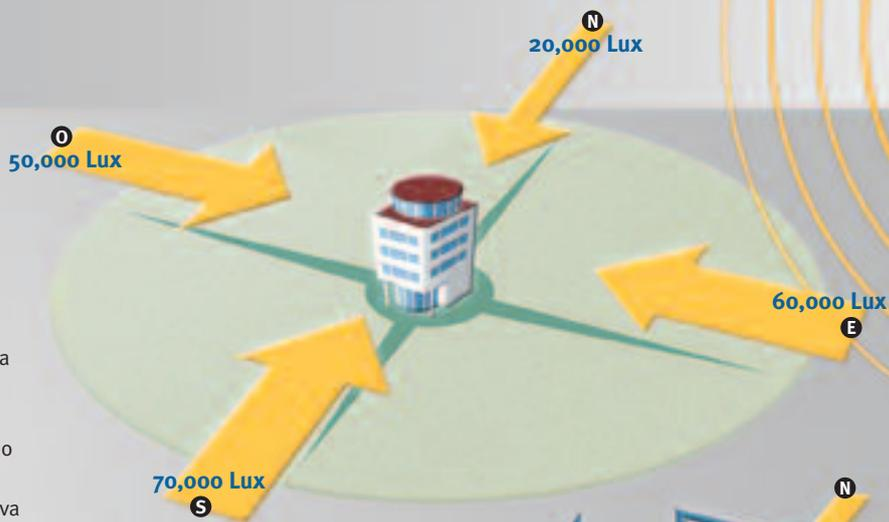
Come esempio generale, si suggeriscono i seguenti valori di trasmissione ammissibili per tenda e per i diversi orientamenti della facciata (presupponendo che non vi si siano fattori di ostruzione causati da edifici alti, o vegetazione ad alto fusto).
